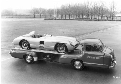
**Schnelltransporter Mercedes-Benz:** il "transporter veloce" con sopra l'auto da corsa W196. L'autocarro raggiungeva una velocità massima di 165 km/h e pesava esattamente tre tonnellate. Il veicolo originale è stato rottamato nel 1967; adesso, la sua copia autentica trasporta le vetture da competizione storiche Mercedes-Benz
