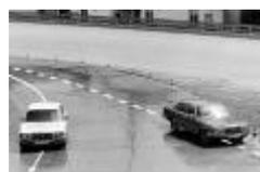
**Classe S Mercedes-Benz berlina della serie 116 con sistema antibloccaggio (ABS) sulla rampa di accesso di Untertürkheim, 1978. Nelle frenate in curva, l'ABS mantiene la vettura stabile e manovrabile, purché i limiti di velocità in curva consentiti dalle leggi fisiche non siano già stati superati.**
